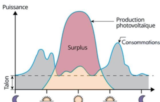
$$\text{Taux d'autoconsommation} = \frac{\text{Production utilisée}}{\text{Production totale}} = \frac{\text{Production utilisée}}{\text{Production utilisée} + \text{Surplus}}$$
